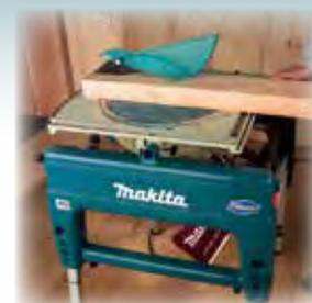
Geliefert mit HM-Sägeblatt 60 Zähne, Staubsack,
